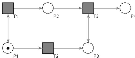
Il est facile de voir que le réseau n'est pas borné puisque la place P4 mémorise tous les tirs de T3. Voici quelques séquences qui montrent ce fait :  $t_1t_2t_3t_3$ ,  $t_1t_1t_1t_1t_2t_3t_3t_3$ , et plus généralement :  $t_1^n t_2 t_3^n$ .
