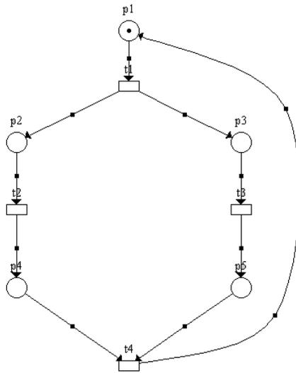
La séquence  $T_1T_2$  est une séquence de franchissement. On pourrait noter : Si  $s = T_1T_2$ , alors  $m_0[s]m_2$ . Par contre, la séquence  $T_1T_4$  n'est pas une séquence de franchissement à partir de  $M_0$ .
