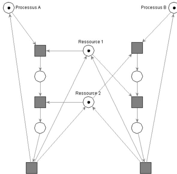
La séquence  $T_1T_4$  mène au blocage.
