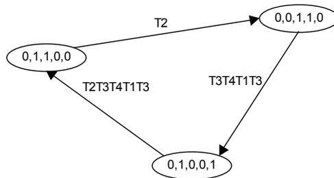
Calculons maintenant le nouveau marquage induit par le franchissement de la séquence  $t_2t_3t_4t_1t_3$  à partir du marquage  $M_0 = (0,1,1,0,0)$
