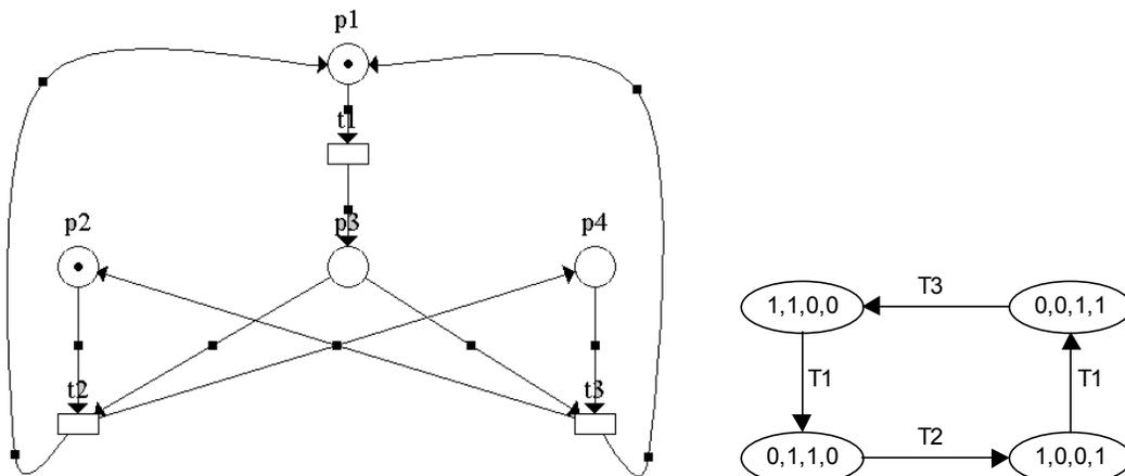
Si on examine le graphe des marquages, il est facile de voir que  $t_1 t_2 t_1 t_3$  est une séquence répétitive.
