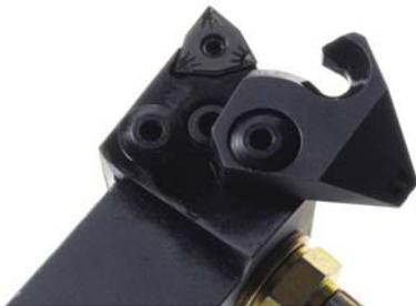
2本のロッキングスクリュを緩め、インデューサを旋回させてチップから離します。インデューサを元の位置に戻す前にチップを通常の方法で変更または割付けて (インデューサの「O」リングが所定の位置からずれていないことを確認してください)、2本のロッキングスクリュを締め付けます。
