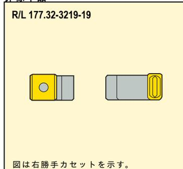
カセットには、チップとカセットの保護のため、アンビルが装着されています。
