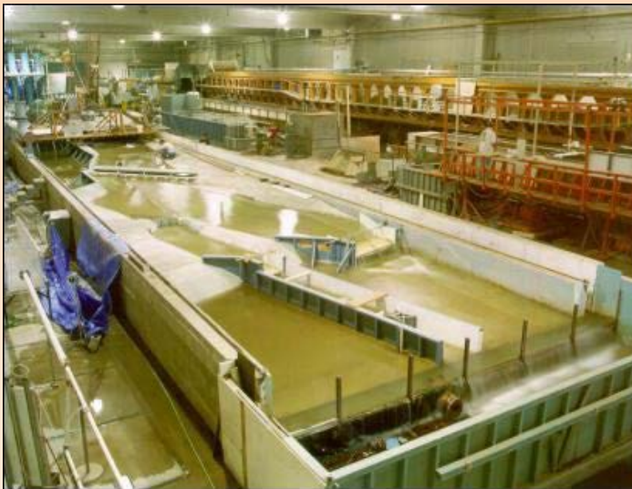
Modelo a escala de un cauce
