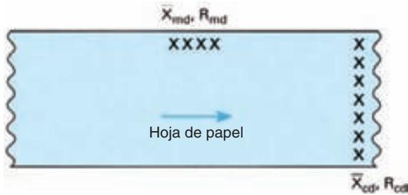
**FIGURA 6-2** Hoja de papel y valores observados para gráficas de control en direcciones de máquina (md) y transversal (cd).
